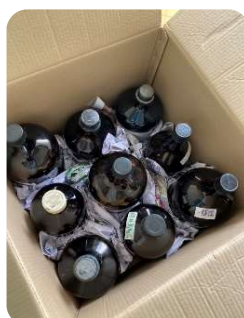
ภาพ แสดงการจัดเก็บของเสียที่บรรจุไว้ในขวดแก้ว ต้องทำการคัดแยกประเภทของเสียที่ทำปฏิกิริยาออกจากรันก่อนบรรจุใส่กล่องที่แพ็คกันขวดสารเคมีกระแทกแตก ซึ่งเป็นอันตรายในระหว่างการขนส่ง
