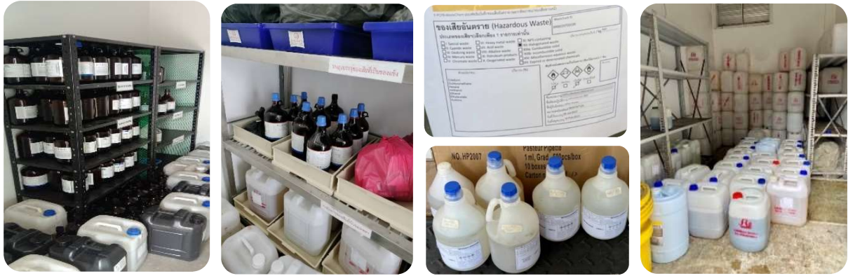
ภาพ แสดงการจัดเก็บของเสียหลังการสร้างระบบการจัดการ Lab Waste โดยติดป้ายชี้ขังชนิดสารเคมีกำกับทุกภาชนะ ที่บรรจุของเสีย และการบรรจุของเสียใส่แกลลอนเพื่อความปลอดภัยในระหว่างการขนส่งของเสียอันตราย
