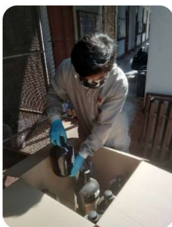
ภาพ แสดงการจัดเก็บของเสียที่บรรจุไว้ในขวดแก้ว ต้องทำการคัดแยกประเภทของเสียที่ทำปฏิกิริยาออกจากรันก่อนบรรจุใส่กล่องที่แพ็คกันขวดสารเคมีกระแทกแตก ซึ่งเป็นอันตรายในระหว่างการขนส่ง
