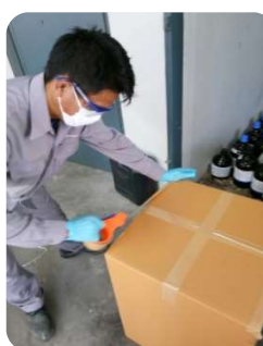
ภาพ แสดงการจัดเก็บของเสียที่บรรจุไว้ในขวดแก้ว ต้องทำการคัดแยกประเภทของเสียที่ทำปฏิกิริยาออกจากรันก่อนบรรจุใส่กล่องที่แพ็คกันขวดสารเคมีกระแทกแตก ซึ่งเป็นอันตรายในระหว่างการขนส่ง
