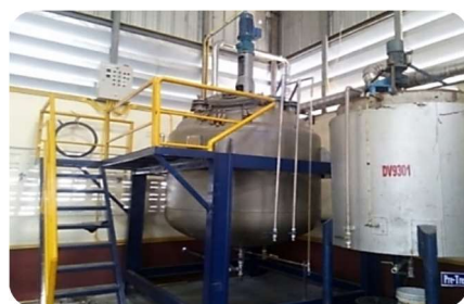
ภาพ Reactor ปรับสภาพของเสียให้เหมาะกับการกำจัดในขั้นตอนสุดท้าย
