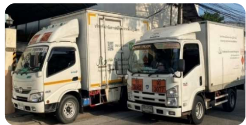
ภาพ รถขนส่งที่ใช้จัดเก็บของเสียเป็นรถขนาดเล็ก มีตู้ที่ปิดสนิทและติดตั้ง GPS
