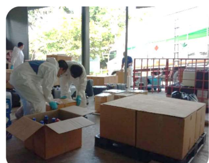
ภาพ แสดงการจัดเก็บของเสียที่บรรจุไว้ในขวดแก้ว ต้องทำการคัดแยกประเภทของเสียที่ทำปฏิกิริยาออกจากรันก่อนบรรจุใส่กล่องที่แพ็คกันขวดสารเคมีกระแทกแตก ซึ่งเป็นอันตรายในระหว่างการขนส่ง
